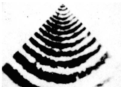
Рис. 2. Голографические интерферограммы на плоско-напряженном клине из инструментальной стали У8А при нагрузке  $P = 5 \cdot 10^3 \text{ Н}$  [7. С. 70]
